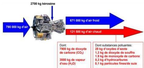
Flux entrants et sortants du moteur CFM56-7b
