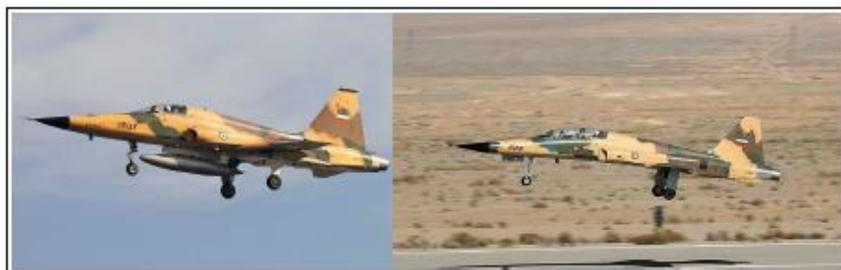
Figure 5: A gauche, un Northrop F-5E Tiger II de l'IRIAF [16]. A droite, un HESA Kowsar également de l'IRIAF, avion conçu sur la base du Northrop F-5E. [17]
