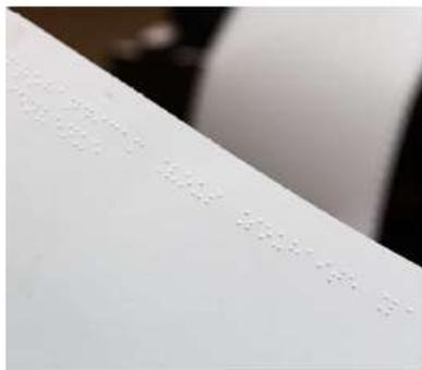
L'informaticienne a écrit « Promhandicam vous souhaite la bienvenue » sur le logiciel The Duxbury Braille Translator et ce dernier l'a transcrit en braille. La seconde photo montre l'impression du message sur du papier braille grâce à l'imprimante braille.
