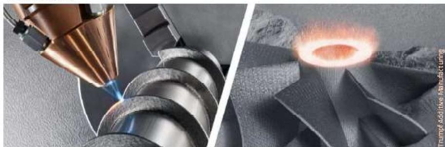
Souvent mieux connue sous le nom d'impression 3D, la fabrication additive est une technique permettant de construire une pièce couche par couche, par opposition aux techniques conventionnelles qui éliminent de la matière. Cette technologie est particulièrement intéressante pour l'industrie aéronautique, qui l'adopte dès la fin des années 80. Très flexible, elle permet la fabrication de pièces complexes et optimisées pour la réduction de la masse, tout en réduisant les pertes d'usinage.
